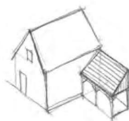
Abri léger orthogonal au bâti principal
