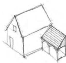
Abri léger orthogonal au bâti principal
